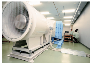
▲低速風洞 飛行機に働く空気の流れや飛行機の周りの空気の流れを調べる実験に用いる装置です。
