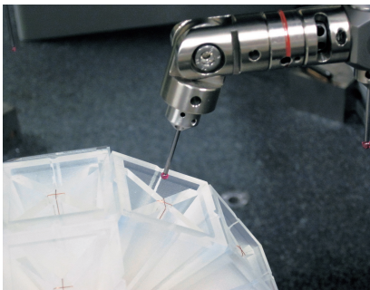
▲脳磁計の性能を確認するための検査標準(ファントム)の校正を行っている様子。
