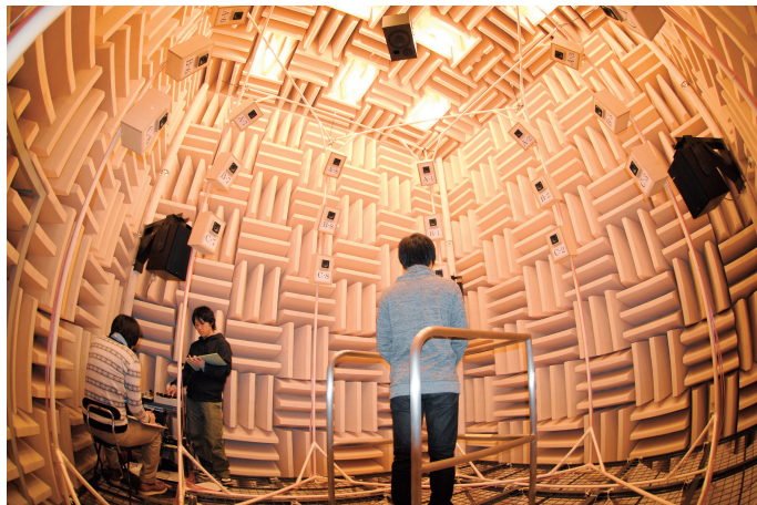
▲「音環境計測システム」設置された6個のスピーカによって立体的に音を再現でき、建築の音環境に関する評価実験などが実施される。
