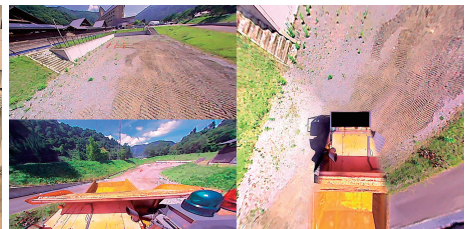
▲遠隔操作中の画面。全方位映像(右)で重機の周囲を確認することができる。
