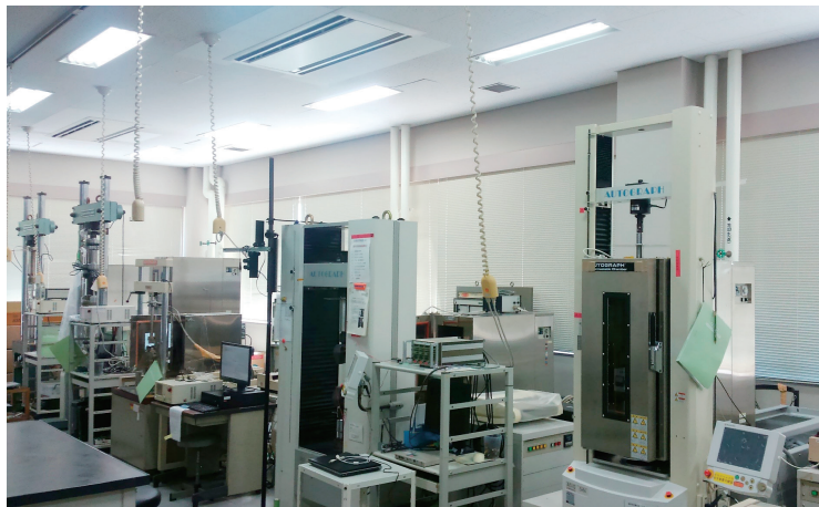
▲ 複合材料強度評価装置群 (精密万能試験機・油圧サーボ疲労試験機)
