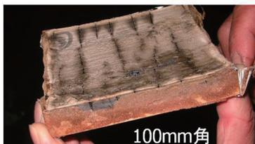
ホウ酸塩を加圧含浸した集成材を、コーンカロリメータで20分加熱した後の外観。上半分のみ炭化し、下半分は木目を保った状態となっている。ホウ酸塩の発泡体と生成した炭化層が内部を熱と酸素から保護する。
