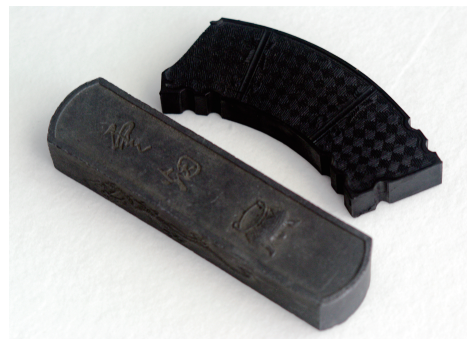
有機分析・有機合成の技法を活用し、製造から100年程度を経た古墨(写真は山水園古墨・上、長春園松煙古墨・下)と同様の表現力を持つ墨の分析・開発を行っています。
