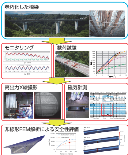
図1 コンクリート橋を対象としたスマート点検システムのイメージ図
