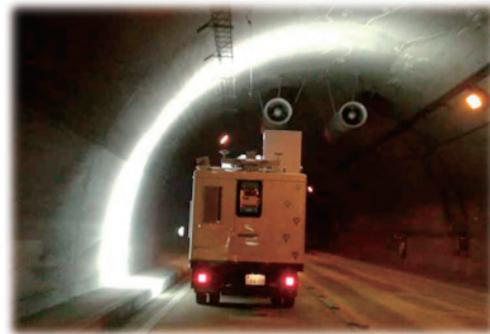
図1 トンネル覆工撮影点検
