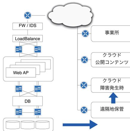
情報システムは、障害によるダウンタイムを削減するために冗長構成を採るが、障害の発生部位や復旧目標時間により構成の検討が必要となる。安定稼働には、性能、容量、コスト、運用性などの設計・評価が重要である。
