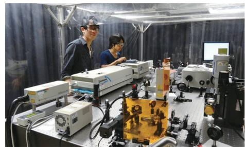
写真は光学実験の様子である。光学テーブル上に、レーザ、光学部品(レンズ、ミラー、フィルター)を配置し、クライオスタット(冷却装置)に設置した半導体に光を当て、そこから出てくる光を分光器で分析している。
