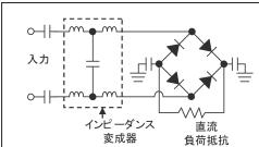
整流効率を高めるため、インピーダンス変成器を設けた新たな構成のブリッジ形高周波整流回路を考案した。本構成における設計条件を解析し、高効率整流を可能とする条件を明らかにした。その結果、100MHzにおいて1W入力時に93.8%の整流効率(整流ダイオード部)を得た。一連の成果は電子情報通信学会やIEEE主催の学会において、全国大会:2件、研究会:1件、国際会議:2件として発表している。
