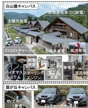
白山麓キャンパスのエネルギーマネジメント社会実証実験システムと、電気自動車 (EV) 関連システムの概要。これらを用いて、様々な実証実験を実施しています。
