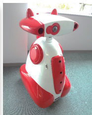
図1: 匂い識別機能を有するロボット。写真は、市販された留守番ロボット(左)と火災早期検知を目的に開発されたロボット(右)
