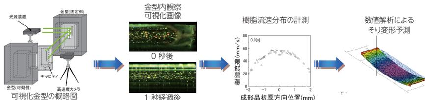
可視化金型を用いて、射出成形中の樹脂流動挙動を高速度カメラで撮影し、画像処理技術によって、樹脂流速を定量化する。この流速による力学的なエネルギーと物性値分布や異質性の関係を定量化し、数値解析に反映させて高精度なそり変形予測技術を確立する。
