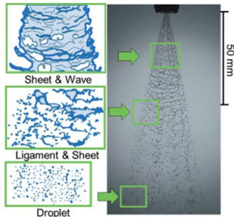
扇形噴流では形成された液膜が分裂して、液滴へと変化してゆく。洗浄は水柱が定常的(時間的な変動が無いような状態)で洗浄対象に衝突するより、非定常的(時間的に変動する状態)に作用するほうが効果的である。
