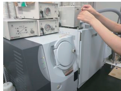
図2 GC-MSによる臭気物質分析
