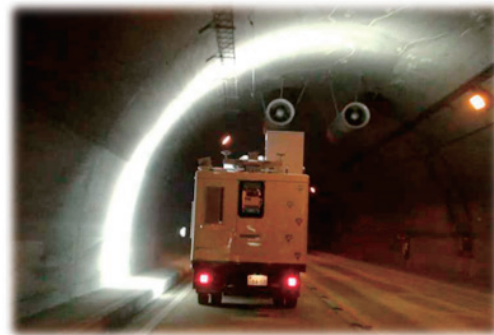
図1 トンネル覆工撮影点検
