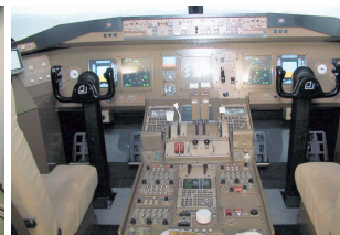
▲フライトシミュレータ 飛行機の操縦を模擬する実験に用いる装置です。
