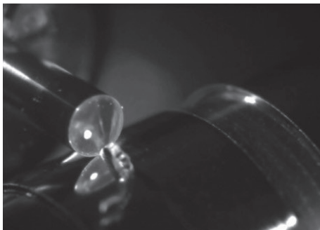
▲駆動形ロータリー工具による焼入れ鋼の高速切削
