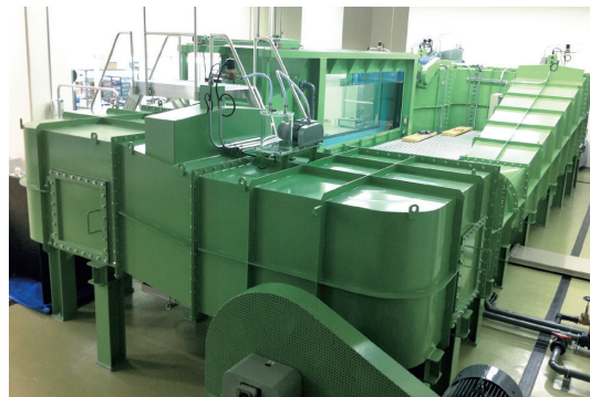
▲水平循環型回流水槽といい、物体に働く流体力計測や物体周りの流れの観察などを行う大型装置
