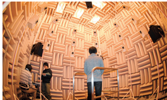
▲「音環境計測システム」設置された6個のスピーカによって立体的に音を再現でき、建築の音環境に関する評価実験などが実施される。
