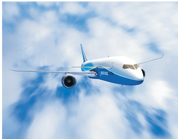
▲ ボーイング社の最新鋭機「ボーイング787」は機体主要部に炭素繊維強化プラスチック（CFRP）を採用しています。当研究所では、CFRPの強さの理由や耐久性などを明らかにする研究に取り組んでいます。
