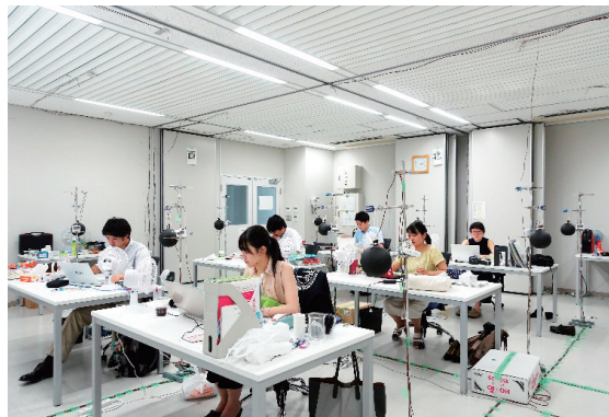
金沢工業大学 地下水利用・天井放射空調システム実験室における被験者試験風景
