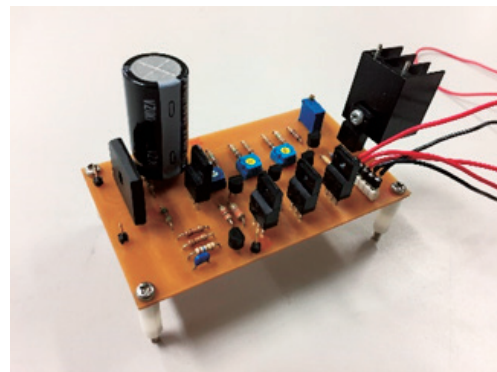
電磁波ノイズの発生しないLED駆動回路 発光効率:90%以上を実現
