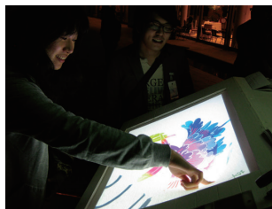
図2 加賀友禅デジタル染め 体験システム 深度センサを用い布を手で触れるだけで、加賀五彩による友禅らしいぼかし染めのデジタル体験ができるシステムを開発。
