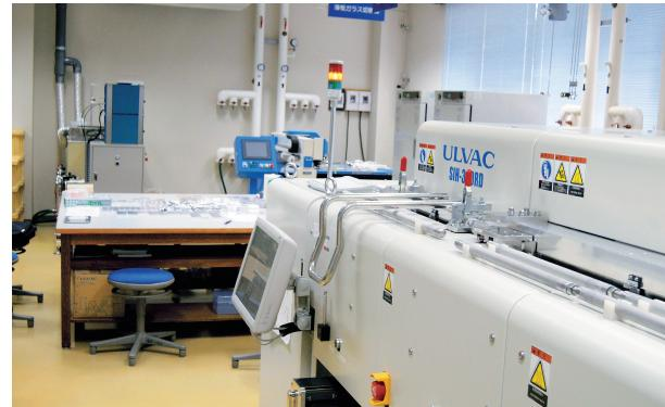
▲ガラス基板の洗浄・切断・成膜システム
