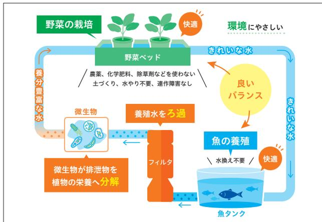
魚の養殖と野菜の水耕栽培を一体化させた生産技術「アクアポニクス」では、自然界で発生する「排泄」「分解」「吸収」「浄化」の流れを利用し、従来の養殖と比較して節水と環境負荷を減らすという利点があることから、生産性と環境配慮の両立ができる持続可能な循環型生産システムの確立を目指しています。
