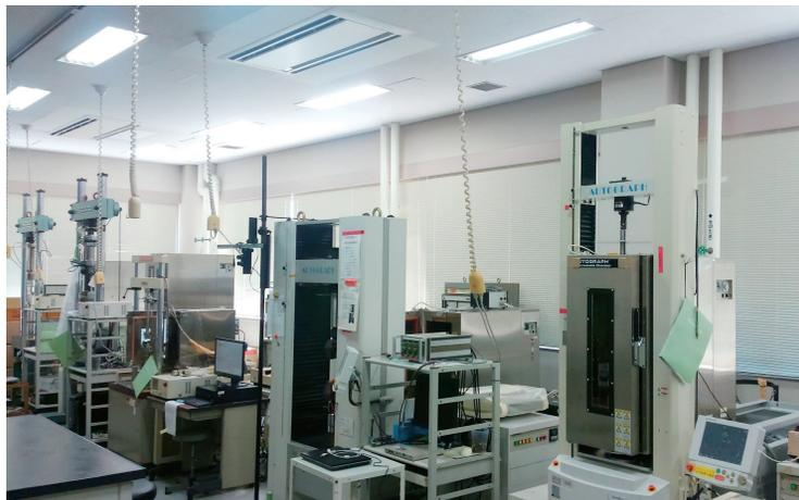
▲ 複合材料強度評価装置群 (精密万能試験機・油圧サーボ疲労試験機)
