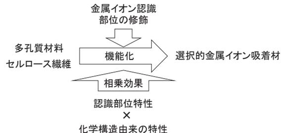
多孔質材料を機能化することにより、吸着能や分離能に優れた新規機能性材料を合成する。機能化多孔質材料を用いて、有害金属イオンの分離除去および有用金属イオンの分離回収を行う。
