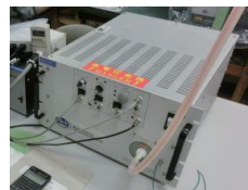
高圧電源: 交直両用高圧アンプリファイア (10/40A-HS-20/20C-HS、Trek) など
