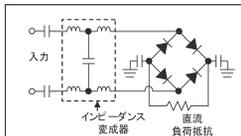
整流効率を高めるため、インピーダンス変換器を設けた新たな構成のブリッジ形高周波整流回路を考案した。本構成における設計条件を解析し、高効率整流を可能とする条件を明らかにした。その結果、100MHzにおいて1W入力時に93.8%の整流効率(整流ダイオード部)を得た。一連の成果は電子情報通信学会やIEEE主催の学会において、全国大会:2件、研究会:1件、国際会議:2件として発表している。
