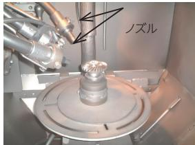
図2.微粒子処理装置の例
