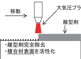
図4.大気圧プラズマによるCFRP処理の模式図
