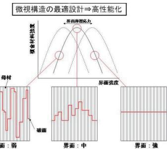
【図の説明】複合材料においては、強化材と母材の界面での接着・摩擦特性がマクロな変形・破壊特性に特に大きく影響を及ぼす。そのため、用途に応じた最適な界面状態の設計が、複合材料高性能化・高機能化のために不可欠である。
