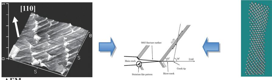
ニッケル単結晶の水素脆性破面のAFMによる観察結果とその破壊メカニズムの模式図
