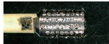
図2 Φ3mmチタン棒に200μm砥粒を固着した工具
