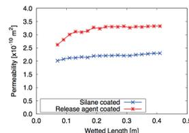
界面特性を変化させた強化繊維に対して樹脂を浸透させることにより、樹脂のしみ込みやすさ(浸透性)は変化する。樹脂浸透試験により浸透性を数値化することにより、浸透性に影響を及ぼす因子を解明する。
