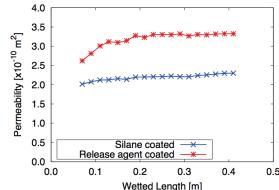
界面特性を変化させた強化繊維に対して樹脂を浸透させることにより、樹脂のしみ込みやすさ(浸透性)は変化する。樹脂浸透試験により浸透性を数値化することにより、浸透性に影響を及ぼす因子を解明する。
