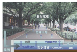
蒸発冷却舗装システムの基本構成と適用空間イメージ
