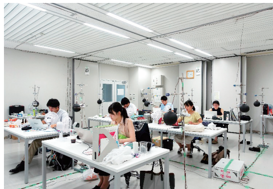
金沢工業大学 地下水利用・天井放射空調システム実験室における被験者試験風景
