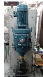
MR流体の伝達応力測定装置
