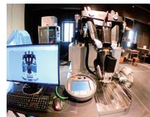
複雑なリンク機構で構成されたロボット型工作機械をモデル化することで、バーチャル空間でのシミュレーションと、実動作をリンクさせたデジタルツインシステムを構築しています。
