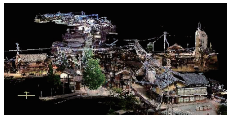
地上型3Dレーザによる石川県白峰地区の点群画像データ(K.I.T.空間情報プロジェクト地上レーザ計測WG提供)
