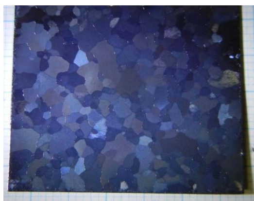
図 3.3-2 高品質多結晶亜酸化銅シート
