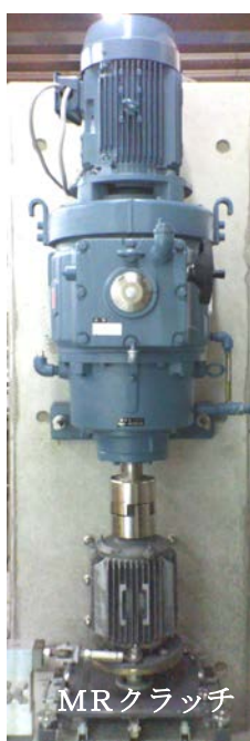
図 3.1-110 MR 流体応力測定装置
