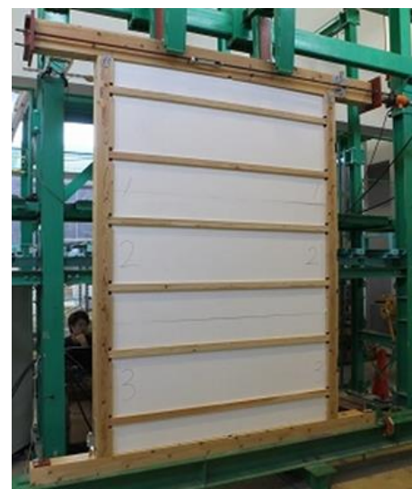
図 13 t3_02 試験体の立面図および全景
