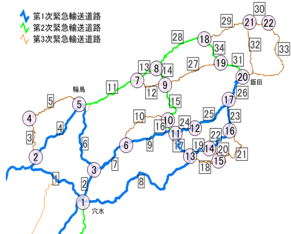
図 5 石川県奥能登地域緊急輸送道路ネットワークのリンクとノードの設定
