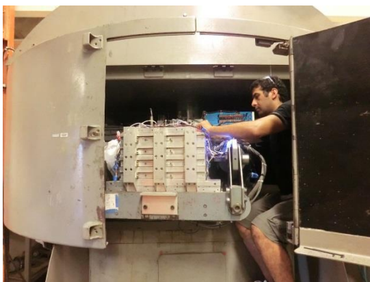
写真 2 UC Davis の小型遠心載荷実験装置
