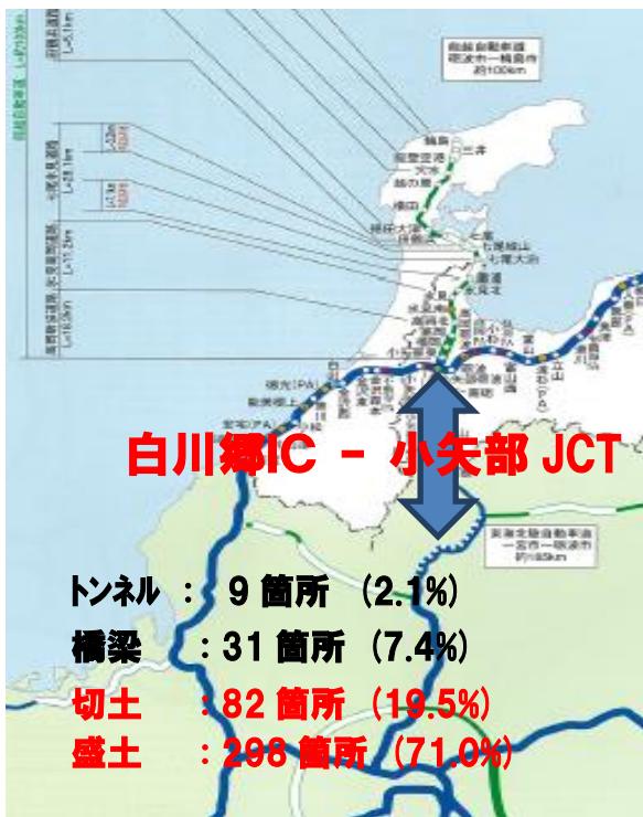
図10 東海北陸自動車道白川郷IC～小矢部JCT区間の道路構造物
