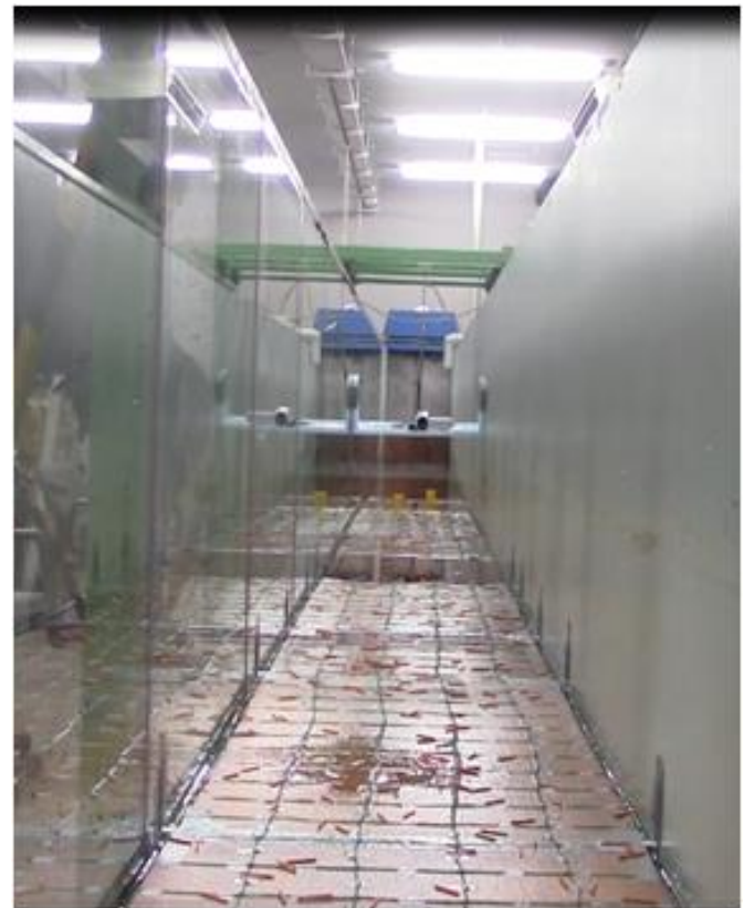
図 28 縮尺地形を設置した断面水槽
