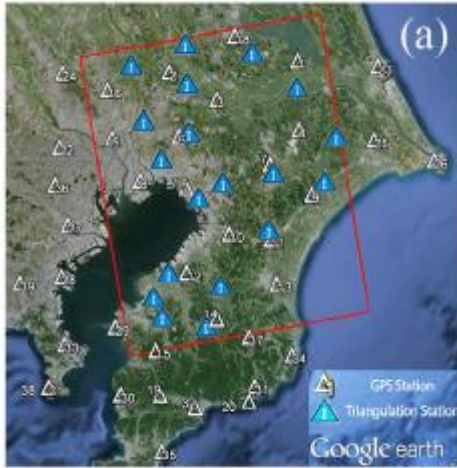
図 18. レーダー画像 (ALOS-PALSAR) の撮影範囲と電子基準点および三角点の位置.
