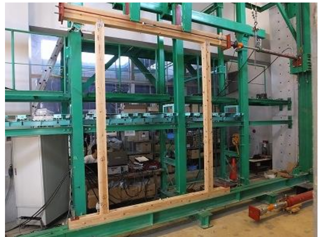
写真 4 試験体の設置状況
