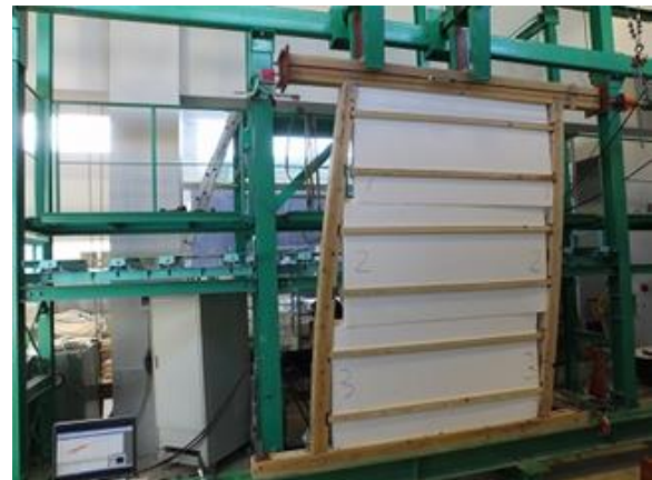
写真5 t3_04の大変形時の損傷状況
