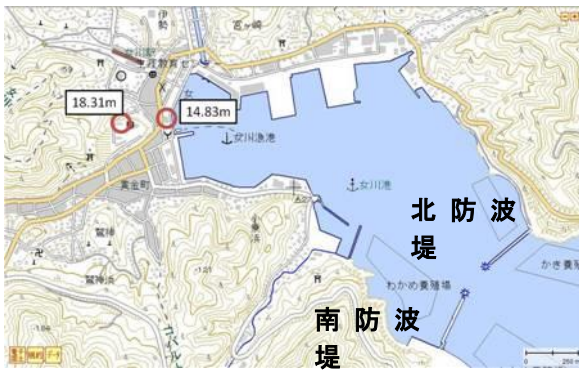
図 5. 女川港の防波堤位置と津波痕跡高さ 1)
