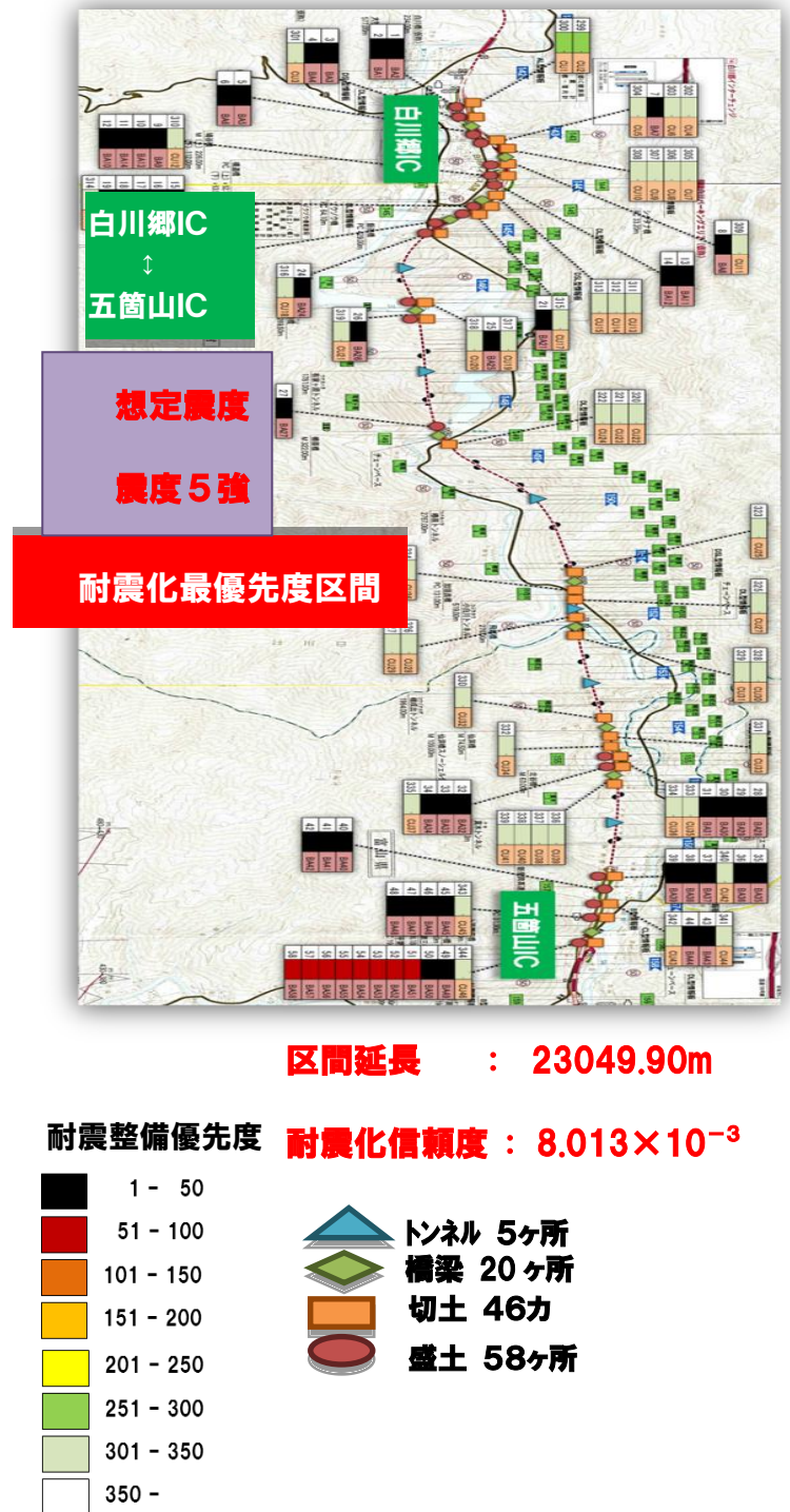
図11 白川郷IC～五箇山IC間の耐震化信頼度と構造物耐震化優先度
