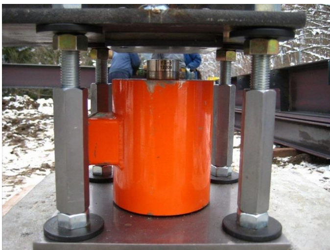
写真 7 床下に取り付けた荷重計
