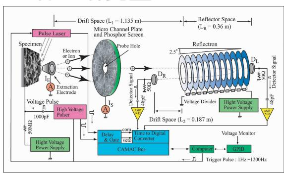
我々は原型となるアトムプローブをもとに、より多様な分析試料への適用を目指し、引出電極の開発などを通して走査型アトムプローブを開発しています走査型アトムプローブについてレーザー脱離支援、電圧~レーザー交互照射、交互脱離などの技術開発と新規試料への適用を併せて進めています
