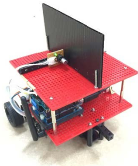
図1. BBV型ガス源探索ロボットの外観
