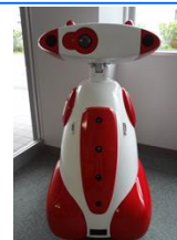
匂いセンサシステムを搭載したセキュリティロボット
