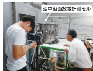
油中沿面放電現象の計測実験
