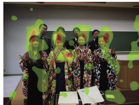
図は視線位置の計測例。数分間の測定で得られた視線位置を積算したもの。この他、単位時間ごとの視線位置の変化や、領域ごとの視線停留回数、視線停留時間などを算出するのが典型的な解析となる。
