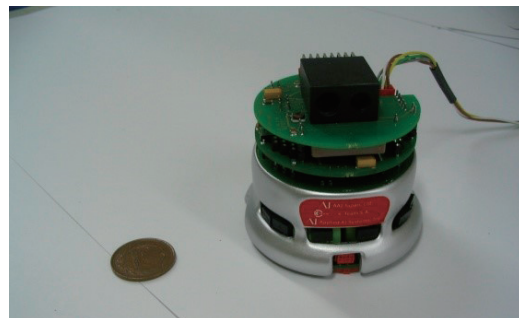
ニューラルネットを使って上に示す小型ロボットを制御してカメラ画像を元に所定のコースを走行させたり、強化学習を用いてゲームを行うシステムの開発を行っている。
